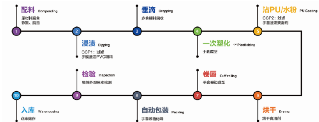
图 6 PVC 手套工艺流程图
