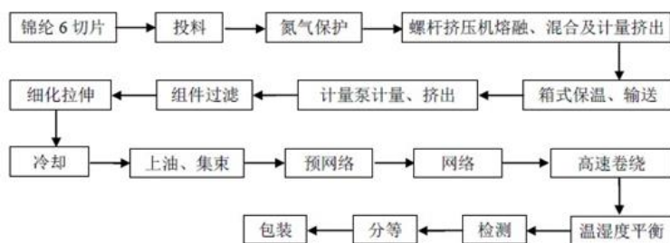
图 7 公司锦纶 POY 生产流程
