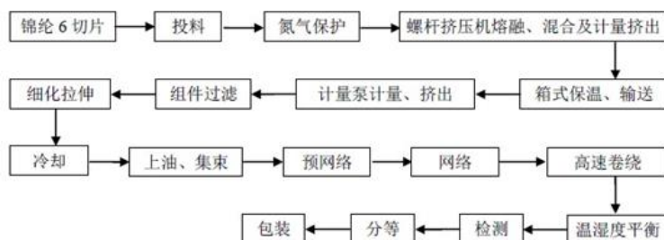
图 7 公司锦纶 POY 生产流程
