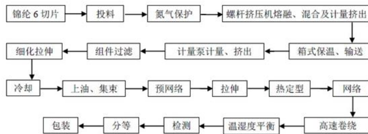
图 8 公司锦纶 FDY 生产流程
